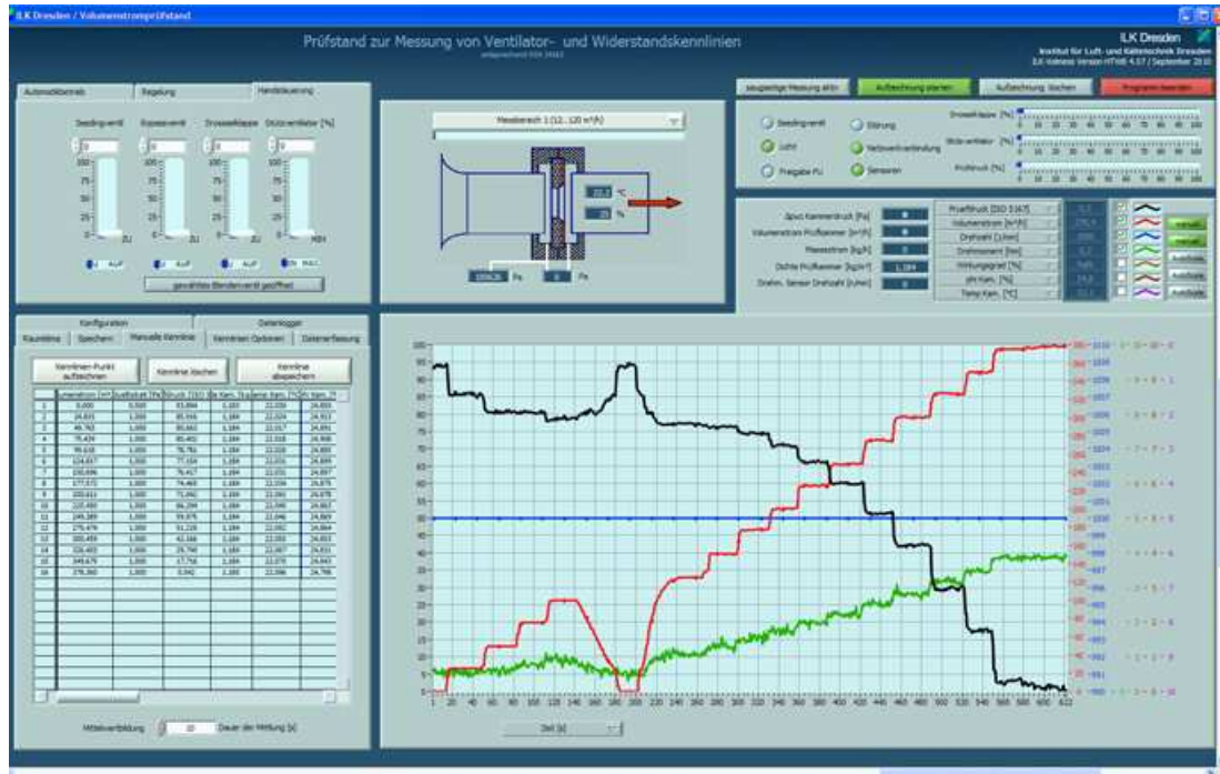
Figura 3-3: Panel de control de la cámara de medición
