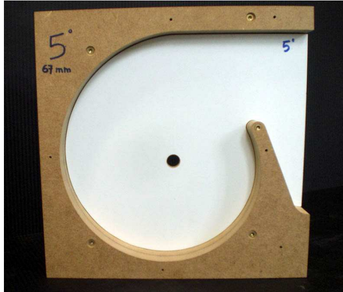
Figura 3-2: Situando la voluta en la posición inicial mediante las piezas de centrado
