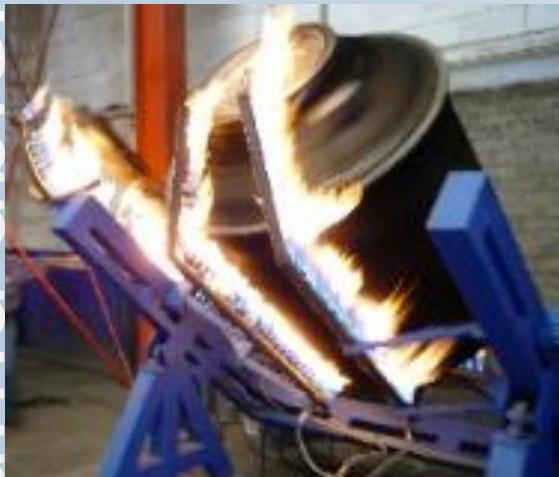
En este tipo de máquinas el calentamiento se realiza mediante varios sopletes, y **no existe horno**, de manera que las **pérdidas de calor** son **mayores** y el ciclo de producción será mucho más largo.
