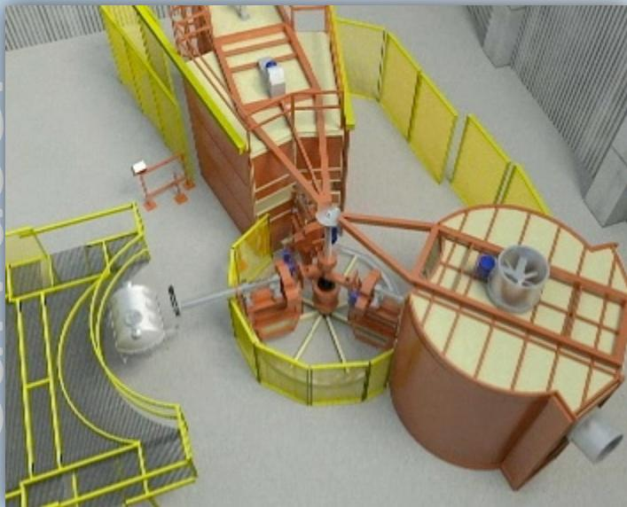
Este tipo de máquina se diferencia de las demás porque el **desplazamiento** en lugar de ser lineal, es **rotacional**.
