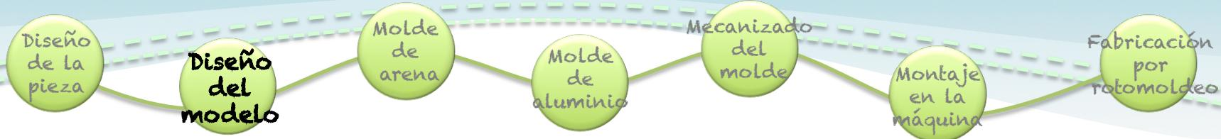
Para la fabricación del molde de aluminio es preciso fabricar una **preforma o modelo** que nos ayude a reproducir la cavidad en la arena.
