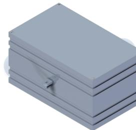
El molde de arena se sitúa bajo la cuchara del horno, para depositarlo cuando esté fundido, y así reproducir la cavidad del molde de arena
