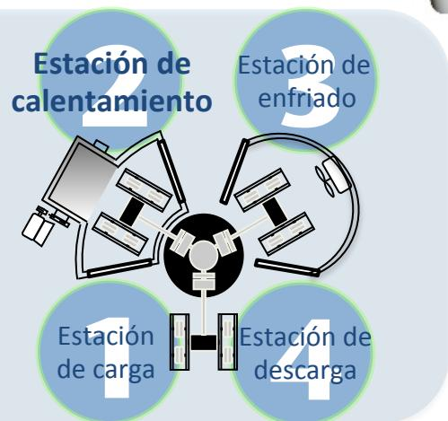
El calor generado en el horno provoca la expansión del molde, del material plástico y del aire que se encuentra en su interior
