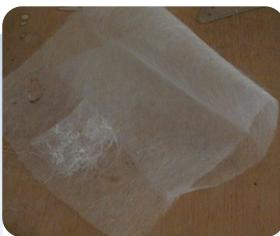
A la preforma de madera se le añade **fibras de vidrio para reforzar**, sobre todo en aquellas partes en las que el espesor no es muy grueso.
