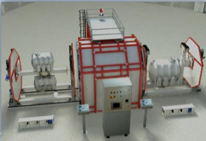
Consiste en una **máquina de desplazamiento lineal**, con un horno central y uno o dos carruajes. Los carruajes entran en un horno, donde se funde el material plástico y se adhiere a las paredes del molde mediante el giro biaxial. Después viajan hasta la estación de enfriamiento para su posterior extracción.
