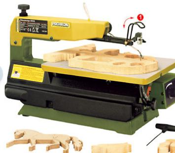
Se corta la madera con la **sierra de calar** en diferentes láminas, para ello se parte del modelo 3d, que se fragmenta en varios **cortes** horizontales para tomar las medidas con las que debemos cortar las diferentes **láminas**.
