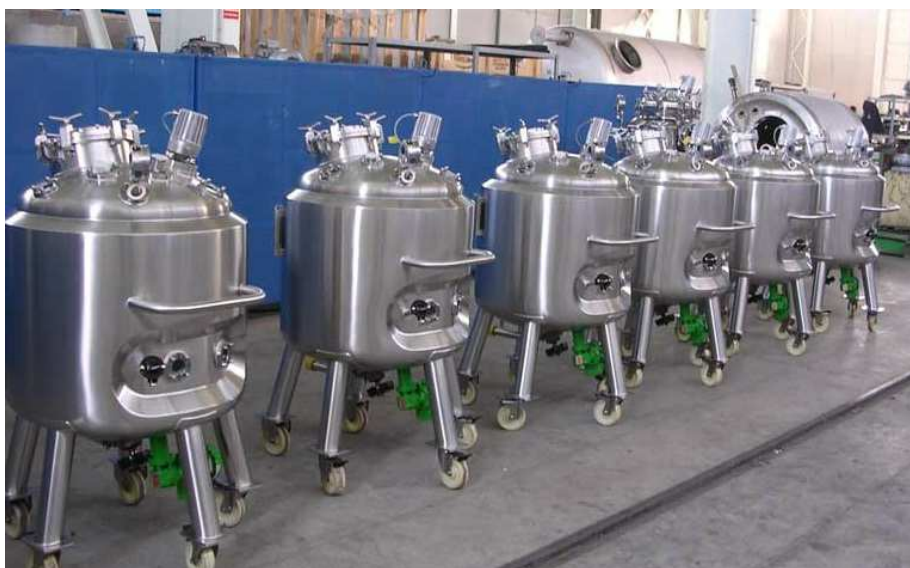
Figura 6. Reactores marca Maivisa. Puede observarse que vienen con bombas en la parte inferior para la descarga y ruedas para su movimiento.
