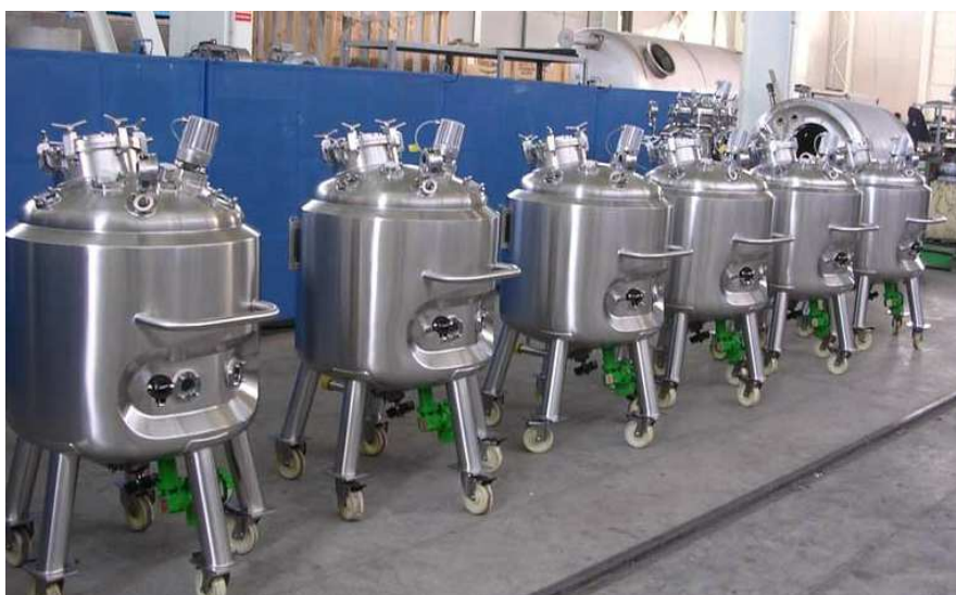
Figura 4. Reactores marca Maivisa. Los aquí representados disponen de válvulas en la parte inferior y ruedas para su manejo por la planta.
