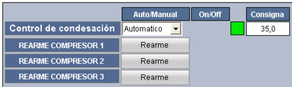
Figura 41 - Detalle rearme compresores y control de refrigeración exterior
