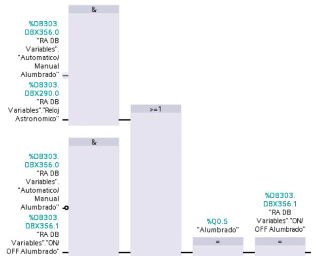
Figura 17 - Detalle Automático/Manual
