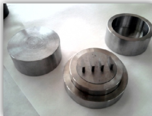
Figura 3.10-Partes del molde(izqda.).Molde montado y lubricado(dcha.).
