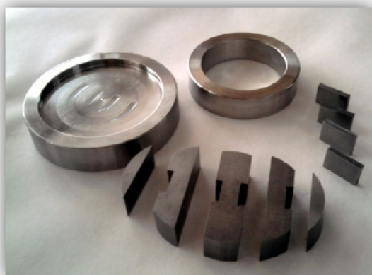
Figura 3.10-Partes del molde(izqda.).Molde montado y lubricado(dcha.).
