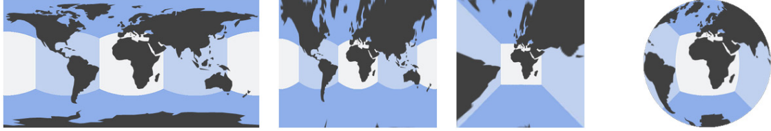
Figura 2.2: Proyecciones más comunes según su campo de vista (en orden): Esférica, Cilíndrica, Rectilinear y Ojo de pez.
