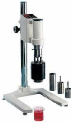
Ilustración 16. Viscosímetro rotacional absoluto
