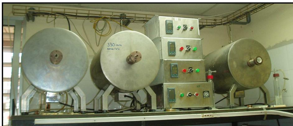
Ilustración 11. Tres hornos que se usan en los procesos de sinterización
