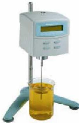
Ilustración 15. Viscosímetro rotacional relativo
