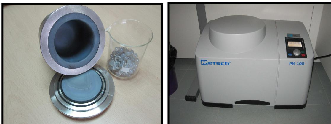
Ilustración 27. Componentes y molino de bolas
