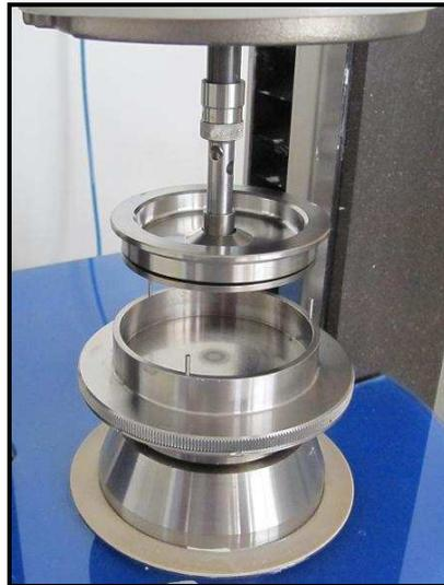
Ilustración 26. Lugar donde se deposita el líquido a examinar
