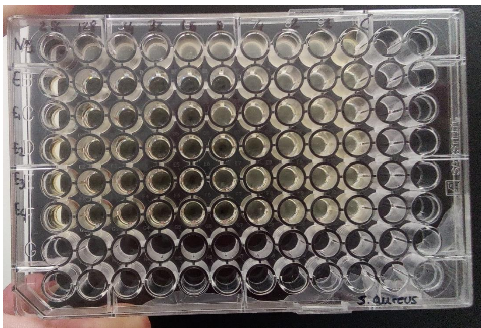
Figura F7. Placa de 96 pocillos tras la incubación de S. aureus para la determinación de la CIM.
