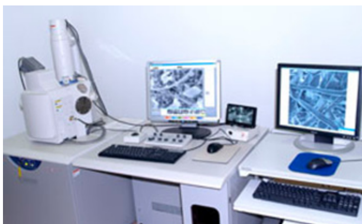
Figura 3.10- Microscopio electrónico de barrido (SEM) Hitachi S-3400N (servicio de análisis del Instituto de Carboquímica (CSIC))
