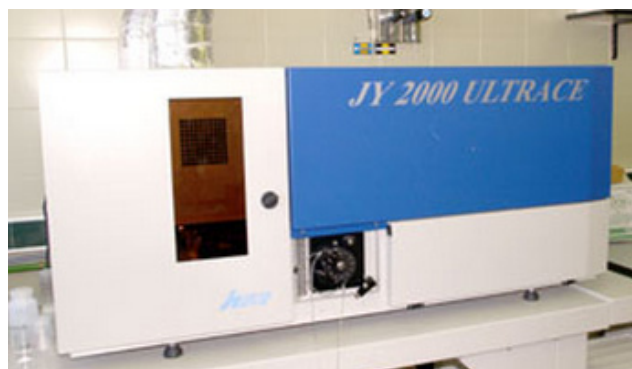
Figura 3.13- Espectrómetro de emisión atómica ICP Jobin Yvon 2000 de configuración radial (servicio de análisis del Instituto de Carboquímica (CSIC))
