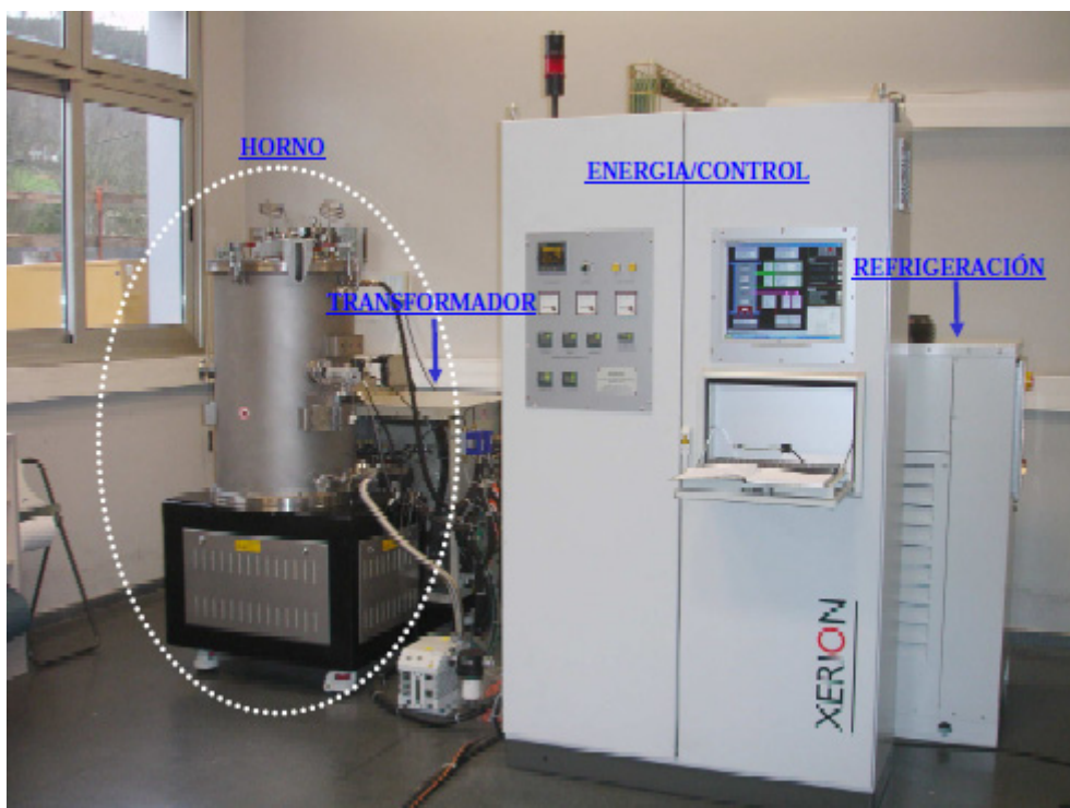
Figura 3.8- Horno eléctrico de grafitización del INCAR
