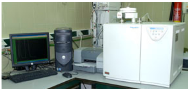
Figura 3.14- Analizador Carlo Erba 1108 y un analizador Termo Flash 1112 para la determinación de carbono, hidrogeno, nitrógeno, azufre y oxígeno (servicio de análisis del Instituto de Carboquímica (CSIC))
