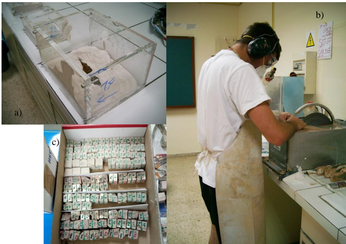
Figura 6: a) Cajas de metacrilato con las muestras en escayola; b) Preparación de las muestras con la sierra radial; c) Muestras obtenidas una vez preparadas en el laboratorio para la medida de la ASM.
