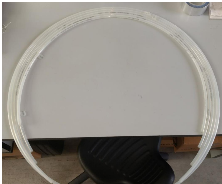
Figura 31: Conjunto de los cinco conductos flexibles de poliamida empleados en la memoria.
