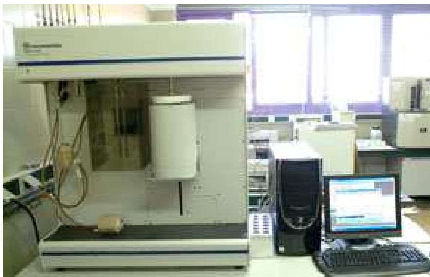
Figura 3.9 - Micromeritics ASAP 2020. Servicio de análisis del Instituto de Carboquímica (CSIC).
