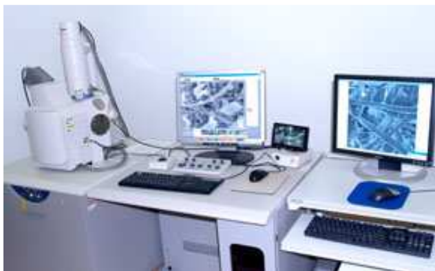
Figura 3.10 - microscopio SEM EDX Hitachi S-3400 N con analizador EDX Röntec XFlash de Si(Li). Servicio de análisis del Instituto de Carboquímica (CSIC).
