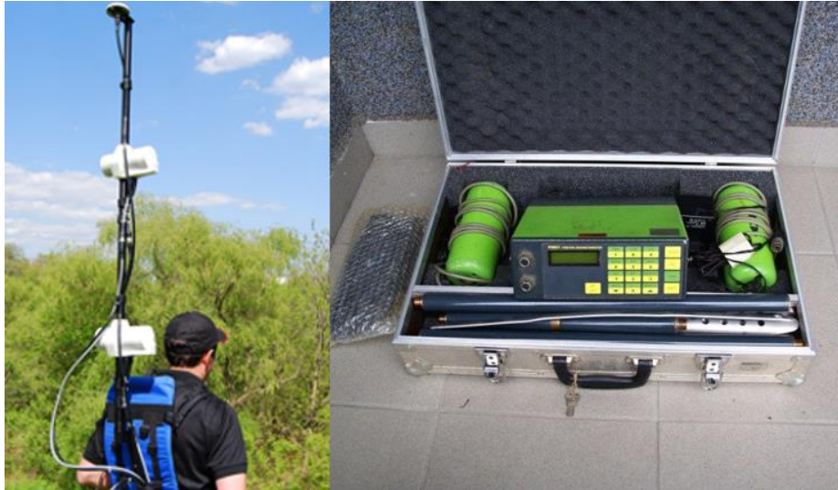
Figura 4. Magnetómetro de campo Overhauser GSM-19 a la izquierda y magnetómetro modelo PMG1 a la derecha.
