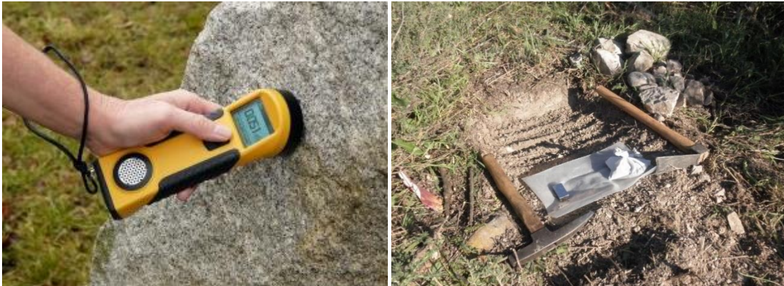
Figura 5. Susceptómetro de mano Terraplus KT-10 a la izquierda. Recogida de muestras a la derecha.
