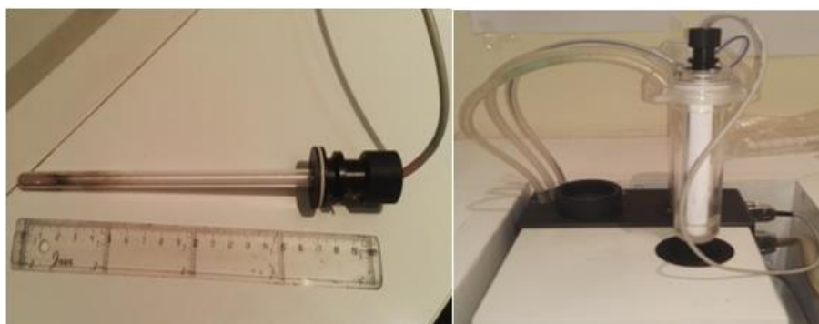
Figura 7. Sistema modular KLY3-S a la izquierda. Adaptador volumétrico y cubos empleados a la derecha.
