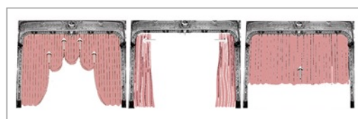
Fig. 179 Tipos de telones. A la veneciana, americana y guillotina de izquierda a derecha.
