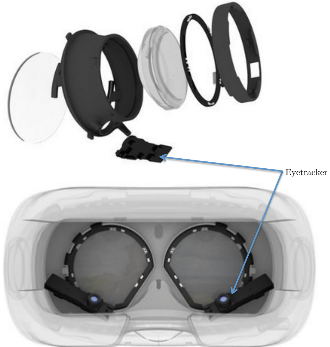
Figura 4.5 Detalles del montaje del eyetracker en el Oculus DK2 (Fuente: Pupil Labs [33])
