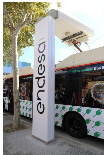
Figura 2.3. Carga inductiva por pantógrafo en Barcelona
