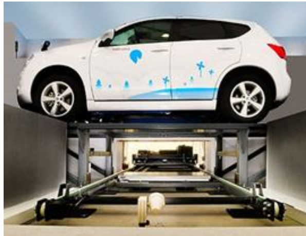
Figura 2.2. Intercambio de batería en un vehículo eléctrico
