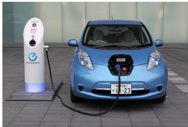
Figura 2.1. Carga de vehículo eléctrico por conducción
