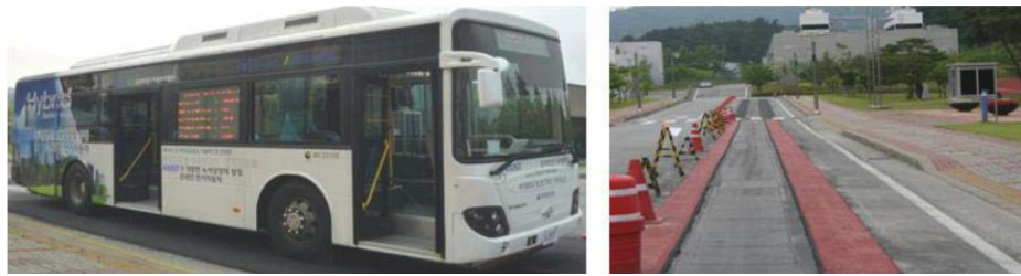
Figura 3.5. Bus eléctrico 2G OLEV y sus raíles de carga de 60 m en el Campus Munji [4]
