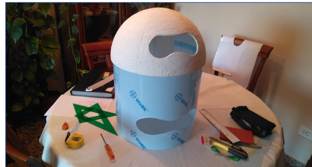
**Fig. 41.** Cabeza y cuerpo del robot ya acopladas. Se puede observar esa similitud entre la forma de los ojos y el agujero del cuerpo para el láser.
