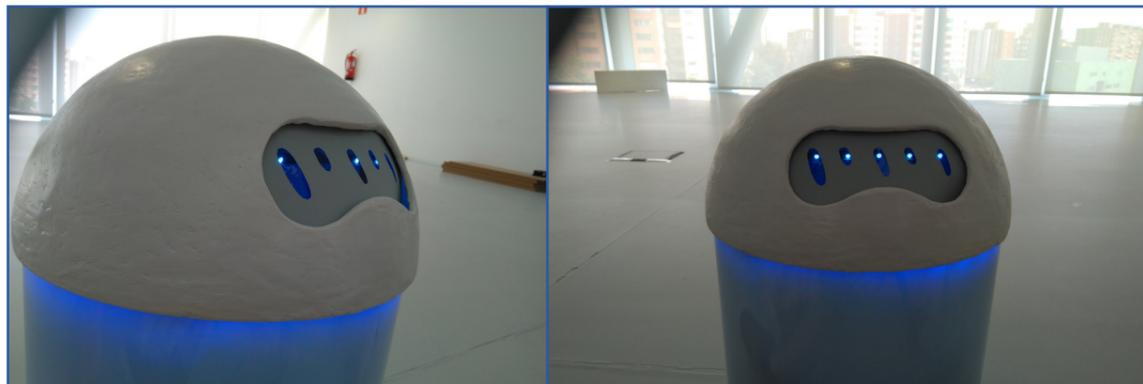
**Fig.13-14.** Prueba de una de las alternativas formales de los ojos desde diferentes posiciones.
