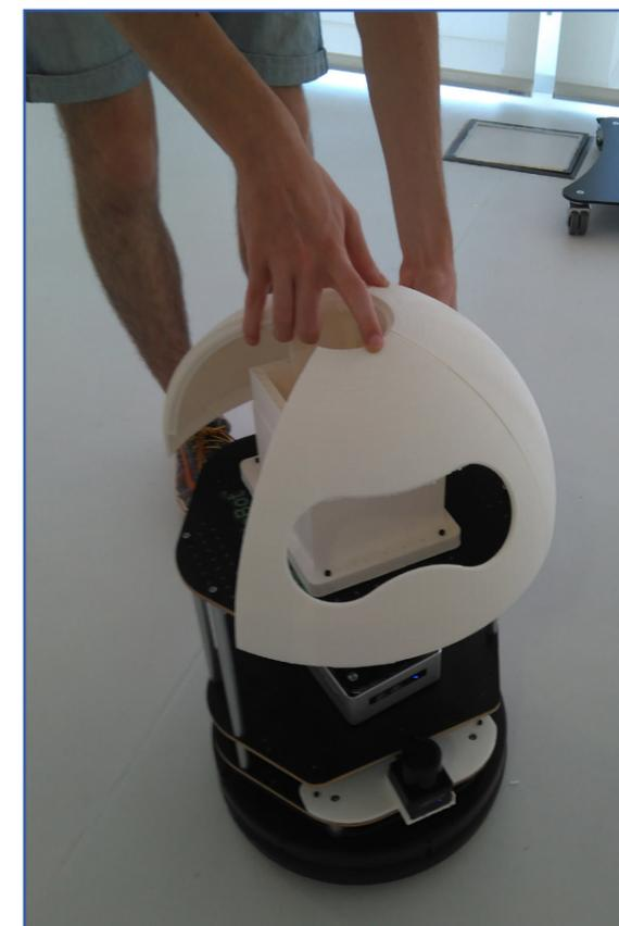
**Fig. 48.** Las tres primeras piezas de la cabeza ya colocadas en el robot. Éstas nos permitían hacernos una idea de como iba a quedar la cabeza y el volumen que iba a ocupar (sus dimensiones).
