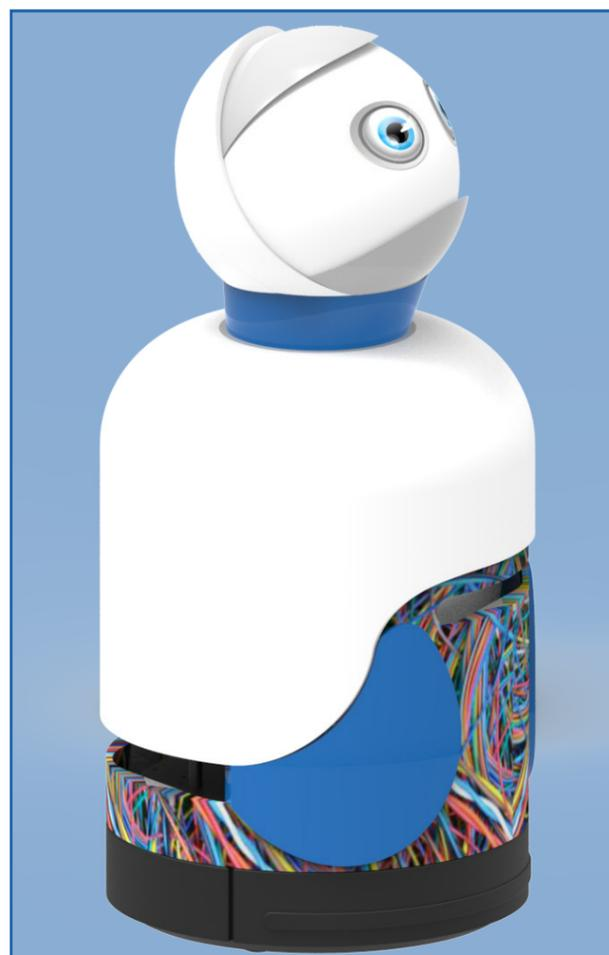
**Fig. 8.** Una de las primeras formas que se realizó de la carcasa del Turtlebot.
