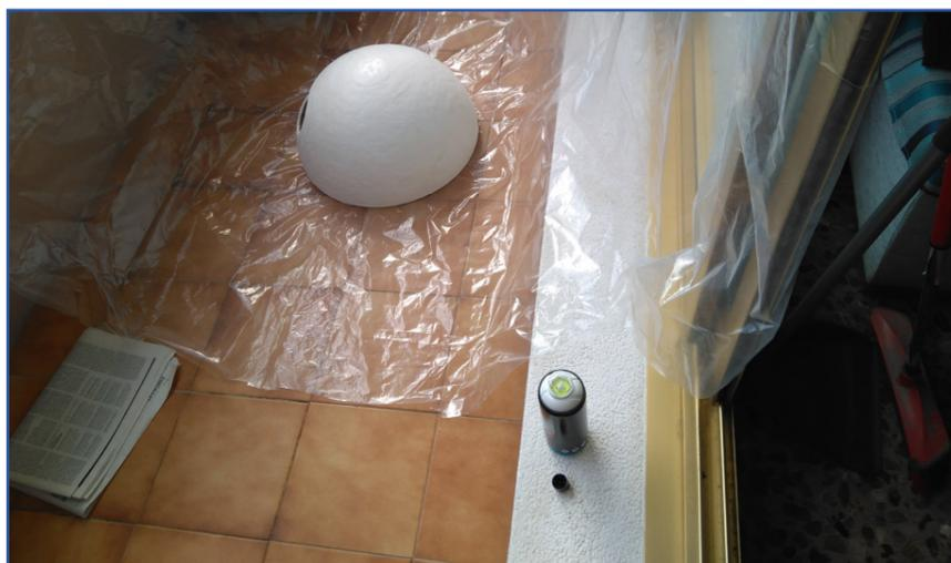
**Fig. 39.** Una vez quedó lisa la cabeza, ya se podía pintar. Para ello se utilizó un spray de pintura blanca metalizada para electrodomésticos. Éste le proporcionó ese acabado brillante y tecnológico que estábamos buscando. Además, como se comentó en la presentación de la parte de diseño el día de la sesión, las carcasas de los robots humanoides de la actualidad poseen cierta similitud con los productos BOSCH (a electrodomésticos).
