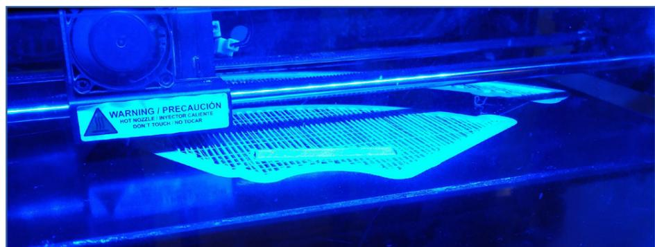
**Fig. 28.** Una de las piezas de la cabeza del robot en sus primeros instantes de impresión. Como se puede observar en la imagen, en ese momento el plato estaba bien calibrado y la pieza se estaba imprimiendo correctamente.
