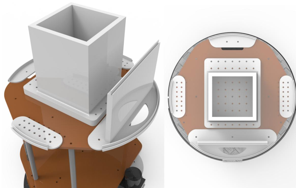
Fig. 20-21. Vista superior y perspectiva de los soportes de los leds y de la cabezadel robot.
