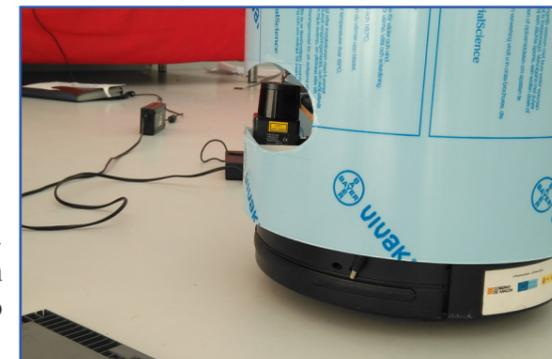
**Fig. 40.** Vista de perfil del agujero del cuerpo. Como se puede observar, no dificulta la visión del láser, por lo que la apertura se había hecho correctamente.
