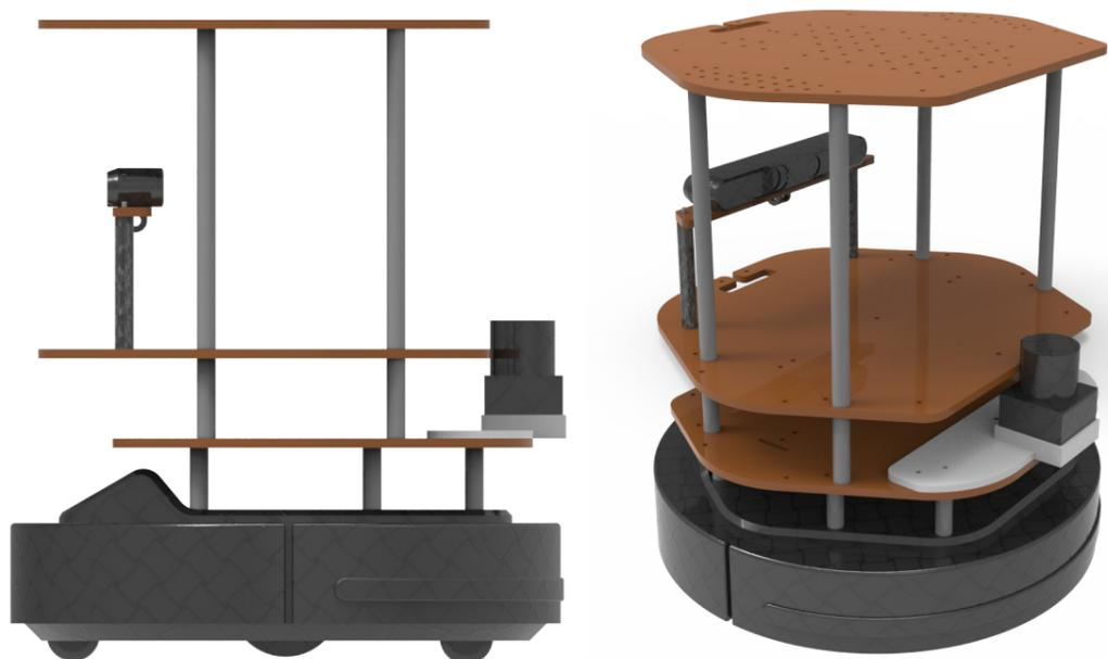
Fig. 18-19. Varias vistas del modelo 3D del Turtlebot con sus componentes internos.
