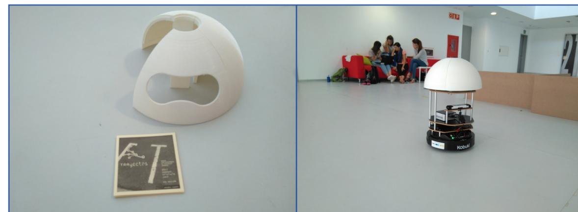
**Fig. 35.** Primeras piezas de la cabeza unidas. **Fig. 36.** La cabeza ya colocada en el robot.
