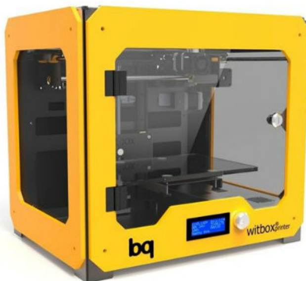
Fig.1. 1 Impresora Witbox de bq, como la que se utilizó para fabricar la mayoría de las piezas de la carcasa.
