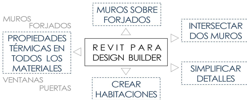
Figura 16. Diagrama de los principales pasos a realizar en Revit para la exportación.
