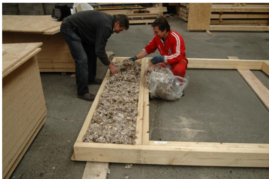
Fig. 66_Construcción en taller de los paneles de entramado ligero. Colocación de la lana de oveja en el interior ( https://www.construction21.org )
