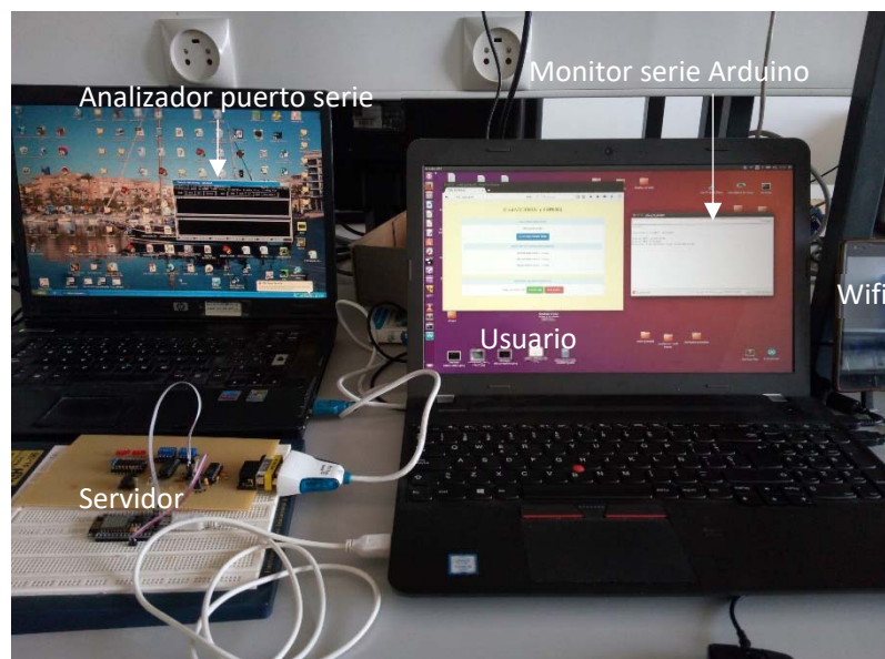
Figura 42. Sistema final de comprobación del programa.
