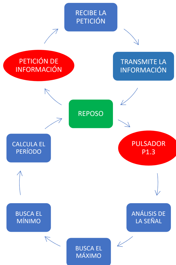
Figura 28. Esquema de funcionamiento del código del microcontrolador.
