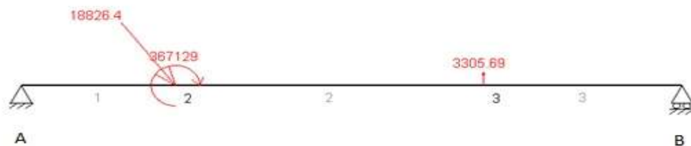
Fig.113- Esquema de fuerzas en el plano xy
