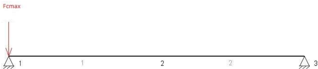
Fig.51- Disposición de la fuerza horizontal en el centro en el plano xz
