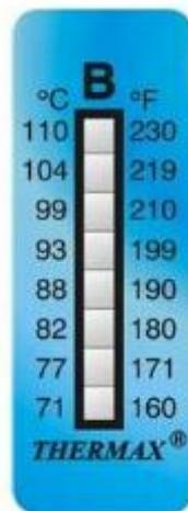
Imagen 18: Tira adhesiva termosensible Thermax. Rango de medición 70-100°C
