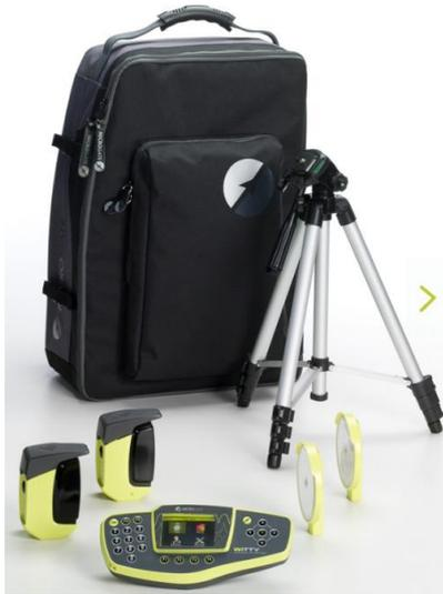
*Imagen 23: cronómetro de balizas Witty System.*
