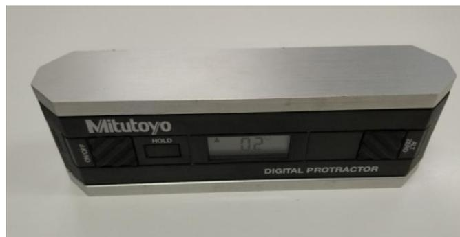
Imagen 2: Inclinómetro Digital Mitutoyo.
