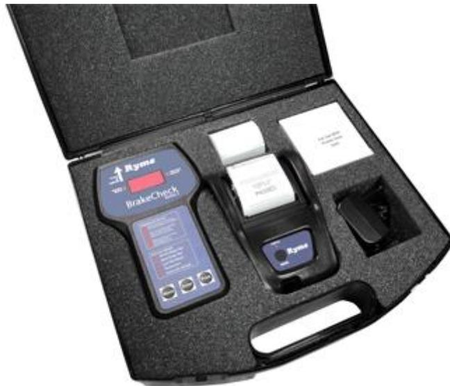
*Imagen 29: Equipo de verificación de frenado BrakeCheck.*
