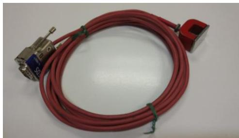
*Imagen 5: Sonda magnética para medición de temperatura PT100 de Conatec.*
