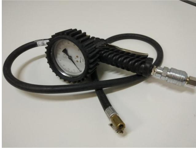
*Imagen 3: Manómetro tubular analógico.*
