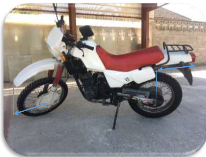
Figura 8.8 Voladizo delantero y trasero
