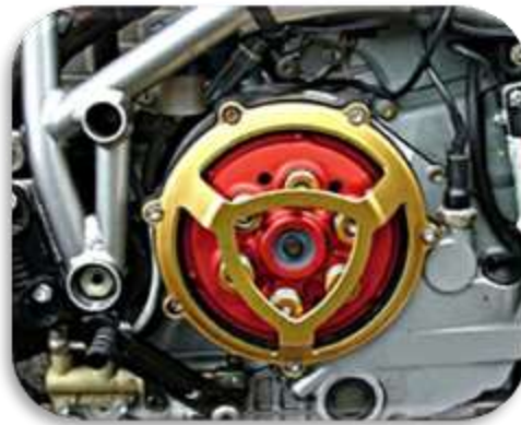
Figura 8.37 Embrague multidisco en seco
