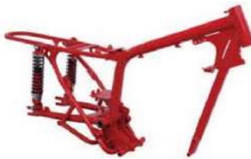
Figura 8.19 Chasis simple cuna abierto
