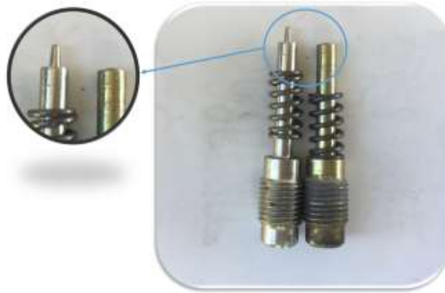
Figura 2.34 Comparación tornillo de mezcla nuevo y viejo
