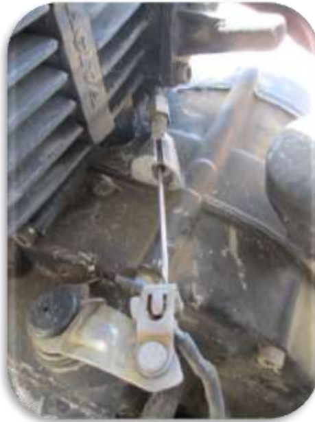
Figura 2.18 Tensor y resorte del embrague
