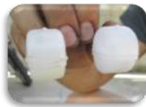
Figura 2.40 Flotador pinchado (izquierda)
