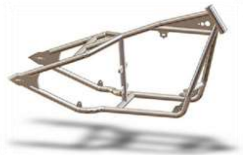
Figura 8.21 Chasis de doble cuna
