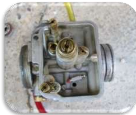
Figura 2.37 Interior de la cuba
