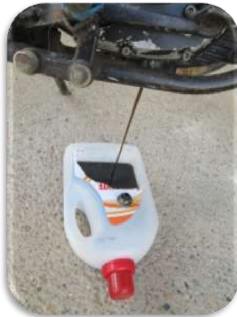
Figura 2.7 Vaciado del aceite
