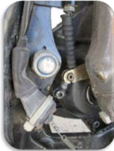
Figura 2.20 Accionamiento descompresor arranque. Resorte
