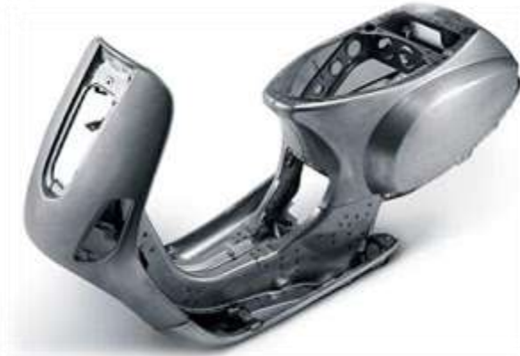
Figura 8.24 Chasis monocasco auto-portante de Vespa
