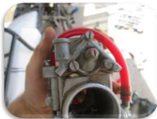
Figura 3.16 Bomba de aceleración del carburador
