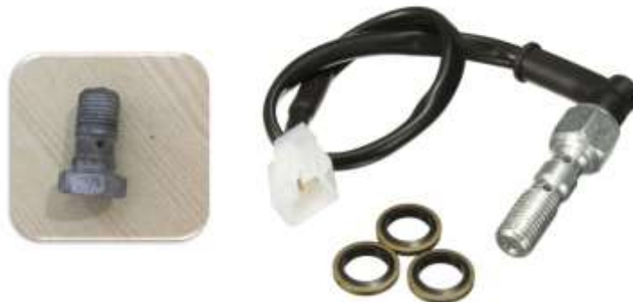
Figura 2.45 Tornillo viejo (izquierda) y nuevo con sensor de presión (derecha)
