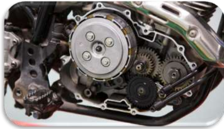
Figura 8.36 Embrague multidisco en húmedo
