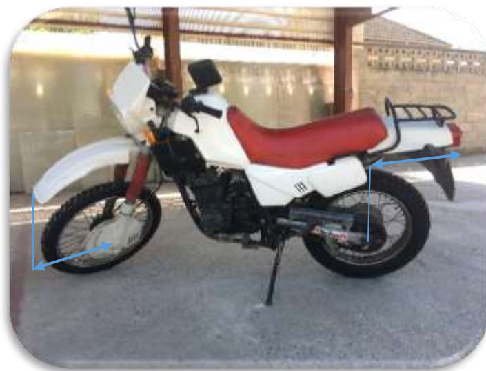
Figura 3.12 Voladizo delantero y trasero
