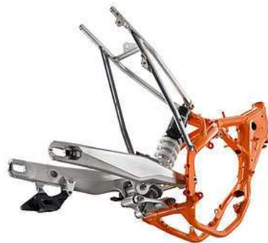
Figura 8.20 Chasis simple cuna desdoblado
