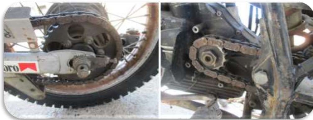
Figura 4.3 Plato (izquierda) y piñón (derecha)
