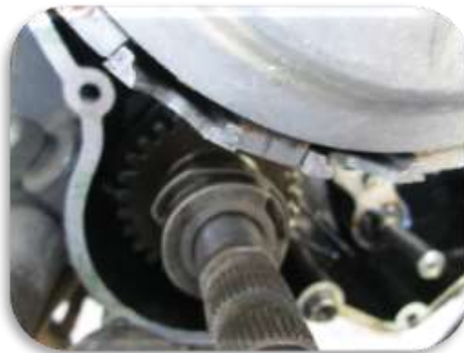
Figura 2.23 Descompresor automático eje arranque
