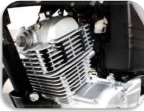
Figura 8.30 Motor refrigerado por aire
