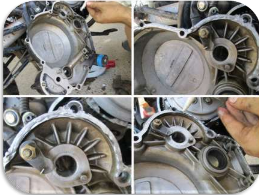
Figura 2.24 Aplicación del sellador
