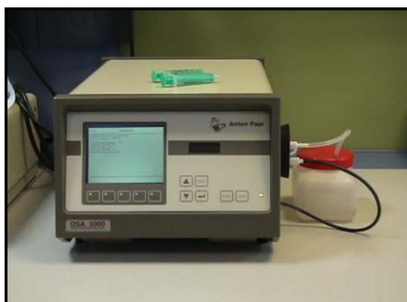
**Figura 2.** Densímetro Anton Paar DMA-5000.
