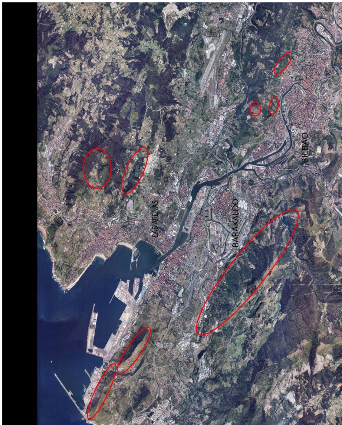
ANEXO II. Riesgo de deslizamientos a ambos márgenes de la ría. Rodeados en rojo, las unidades susceptibles.
