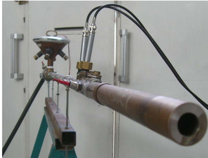
Figura J.1 Configuración medición impedancias de salida
