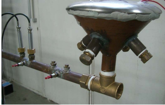
Figura J.3 Posición altavoz para medida de impedancias de entrada
