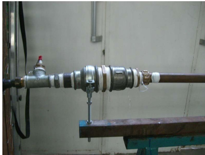
Figura J.4 Detalle de la entrada de la instalación cuando se miden impedancias de entrada.
