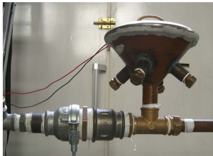
Figura J.2 Detalle cámara anecoica y altavoz
