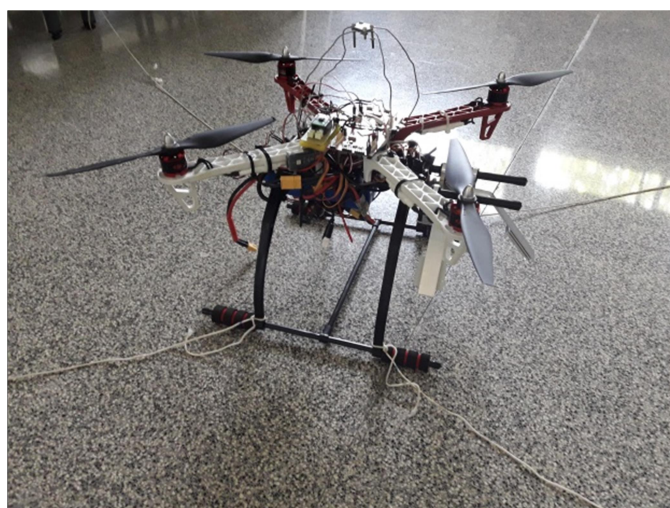
Figura 5.2: Imagen del drone asegurado mediante cuerdas
