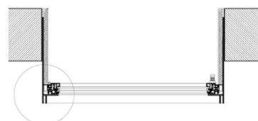
Fig. [64] – Detalle de una de las ventanas de estudio. Se trata de una ventana oscilobatiente. En la sección en planta se marca el detalle de estudio. Fuente: Octavio Mestre,
