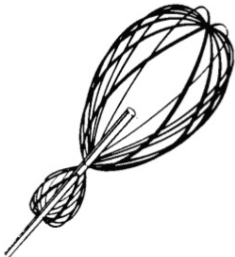
Figura 120: Ejemplo de patrón polar de un transductor ultracardioide
