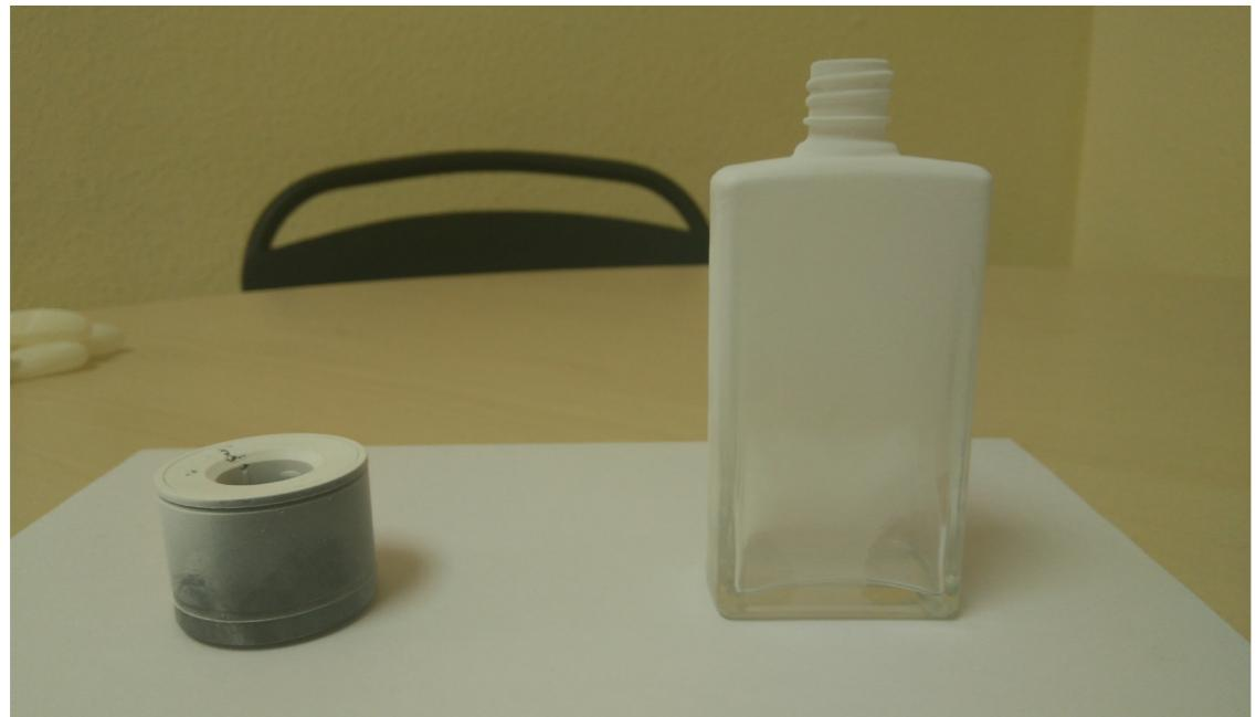
Al principio se escaneó con una máquina de baja resolución por lo que los resultados obtenidos fueron bastante malos ya que no se veían los detalles y las partes importantes. Se realizó otro escaneo con un escáner con mayor resolución y se obtuvieron los archivos CAD para poder meter a Inventor y realizar los tapes definitivos para el frasco.
