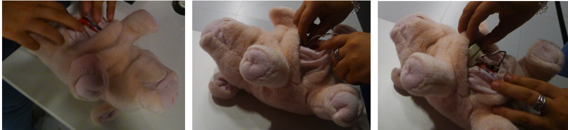
(a) Dispositivo ‘ToyBox’ dentro del cerdito (b) Conexión del pulsador a ‘ToyBox’ (c) Pulsador colocado en la tripa del cerdito
