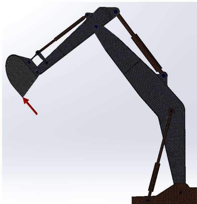
Imagen 2.118. Mallado de la posición base a 85°
