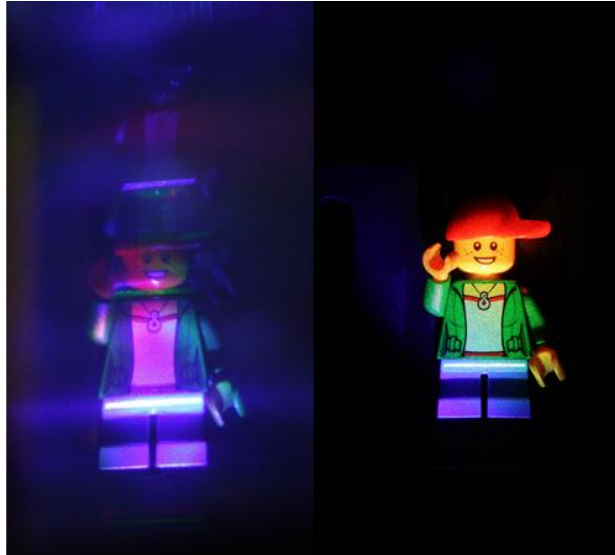
Figura 15: Comparación del holograma realizado (figura de la izquierda) con el método de exposición simultánea con distinto tiempo de exposición con el objeto real iluminado con los tres láseres (imagen de la derecha).
