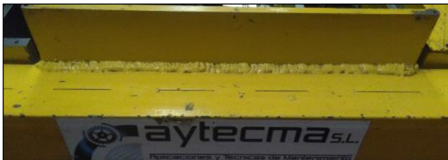
Ilustración 19. Soldadura ensamblaje chasis principal y depósito
