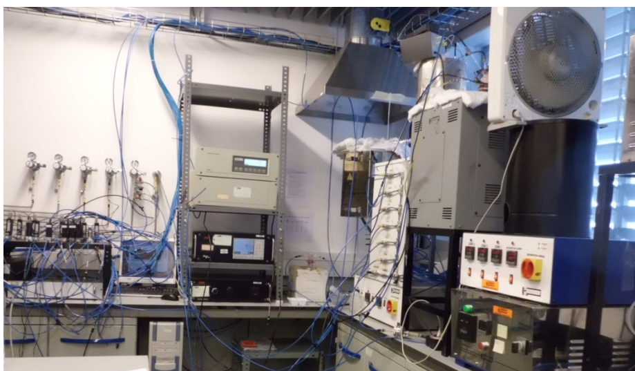
Figura B.1 Imagen del sistema de alimentación y reacción para la oxidación de mezclas acetileno-DME y su interacción con NO.
