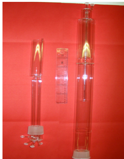
Figura B.11 Imagen de las dos partes de las que consta el reactor.
