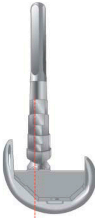
Figura 26. Montaje de la vaina femoral. Tomada de técnica quirúrgica.
