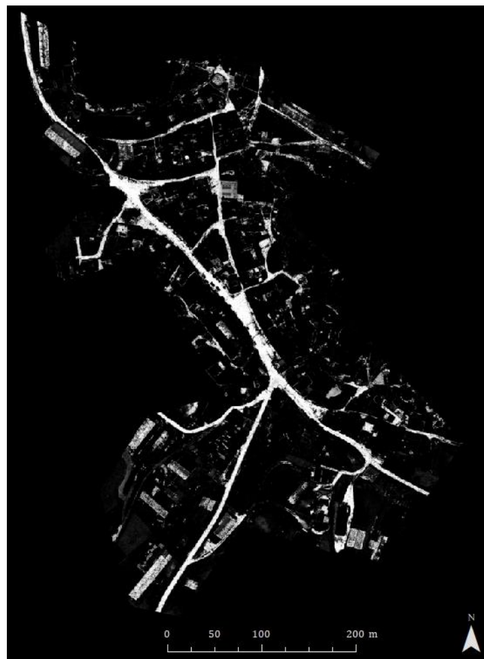
Figura 4. Ráster Pixel Procesor correspondiente al núcleo de Langa del Castillo. En blanco, zonas con alta probabilidad; en negro, píxeles con baja probabilidad.
