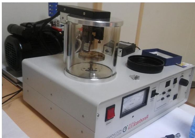
Figura 10. Recubridor de carbono Cressington Carbon Coater 108 carbon/A. Fuente: Elaboración propia.
