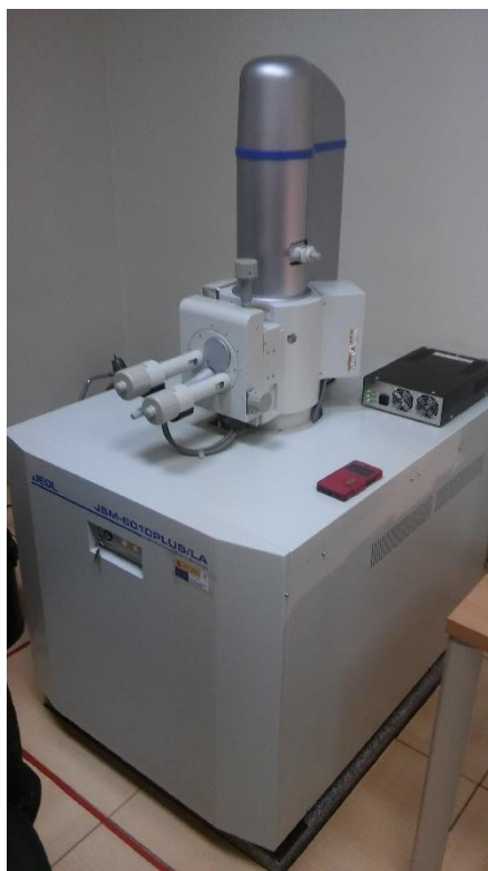
Figura 9. Microscopio electrónico de barrido, modelo JEOL-JSM-6010 PLUS/LA. Fuente: Elaboración propia.
