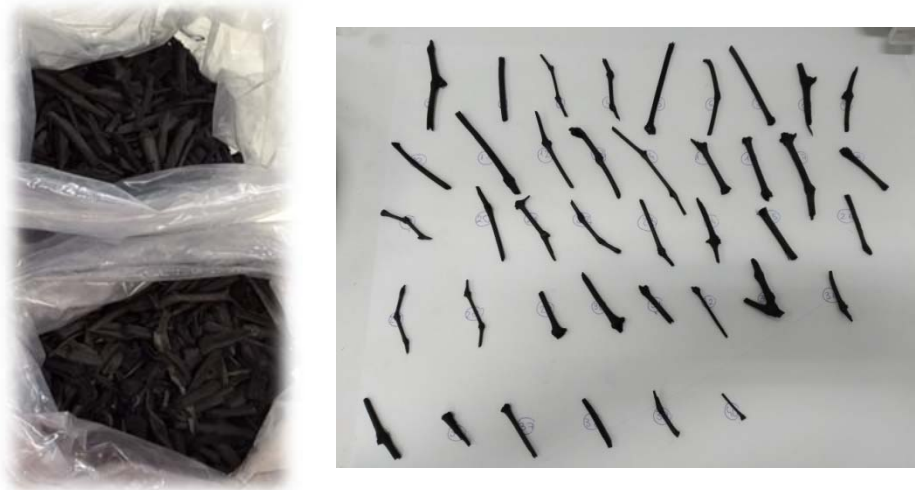
Figura 11. Biochar a la salida del reactor. Gránulos de biochar que suponen el 10% en peso de fracción gruesa en una de las muestras
