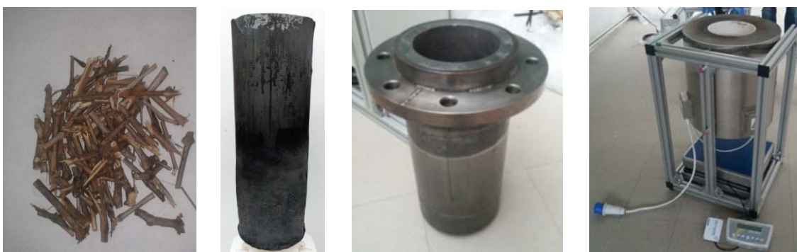
Figura 8. Sarmiento, Cesta, reactor y horno del sistema de pirólisis.
