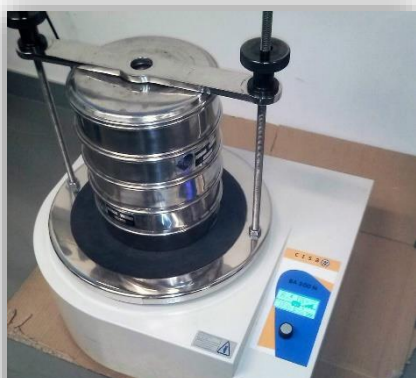
Figura 22. Tamizadora CISA modelo BA-300N.
