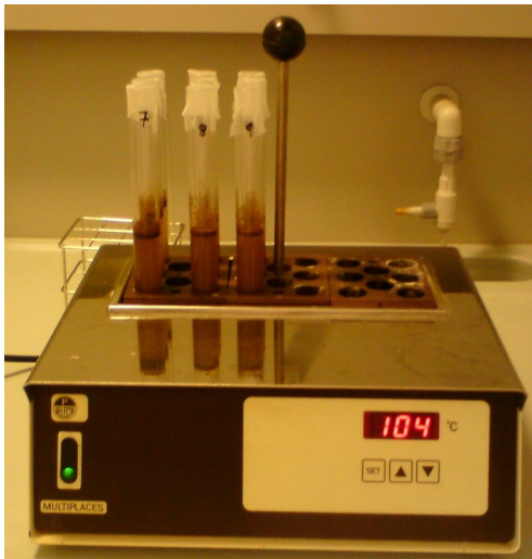
Foto 5 y 6: Proceso de hidrólisis ácida y proceso de filtración al vacío de muestra hidrolizada
