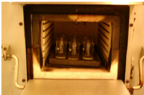
Foto 7 y 8: Muestras preparadas para calcinar y preparación de muestras para analizar la textura del suelo de Tella
