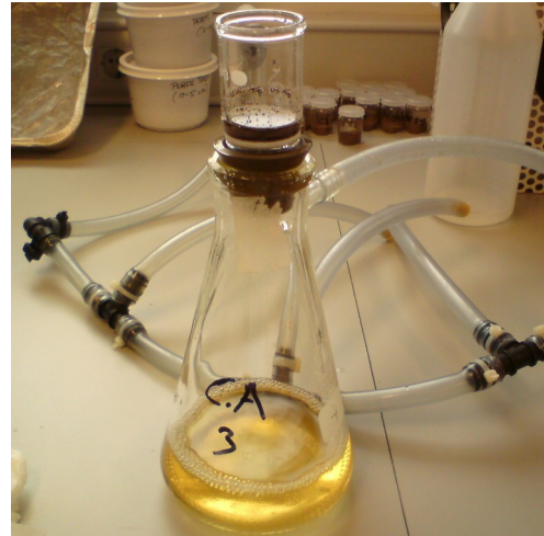
Foto 5 y 6: Proceso de hidrólisis ácida y proceso de filtración al vacío de muestra hidrolizada
