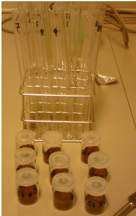
Foto 3 y 4: Muestras antes y después de la hidrólisis ácida
