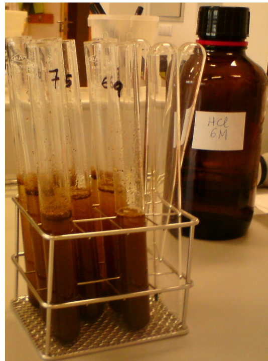
Foto 3 y 4: Muestras antes y después de la hidrólisis ácida
