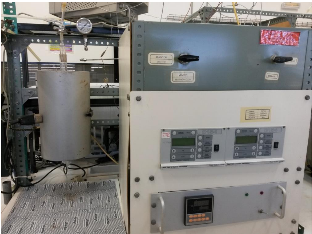
Figura I.1. Reactor vertical de lecho fijo.
