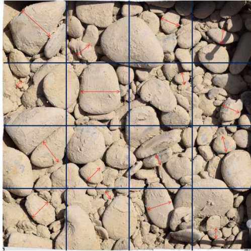
Figura 2: Ejemplo de la cuadrícula utilizada en el método de acorazamiento
