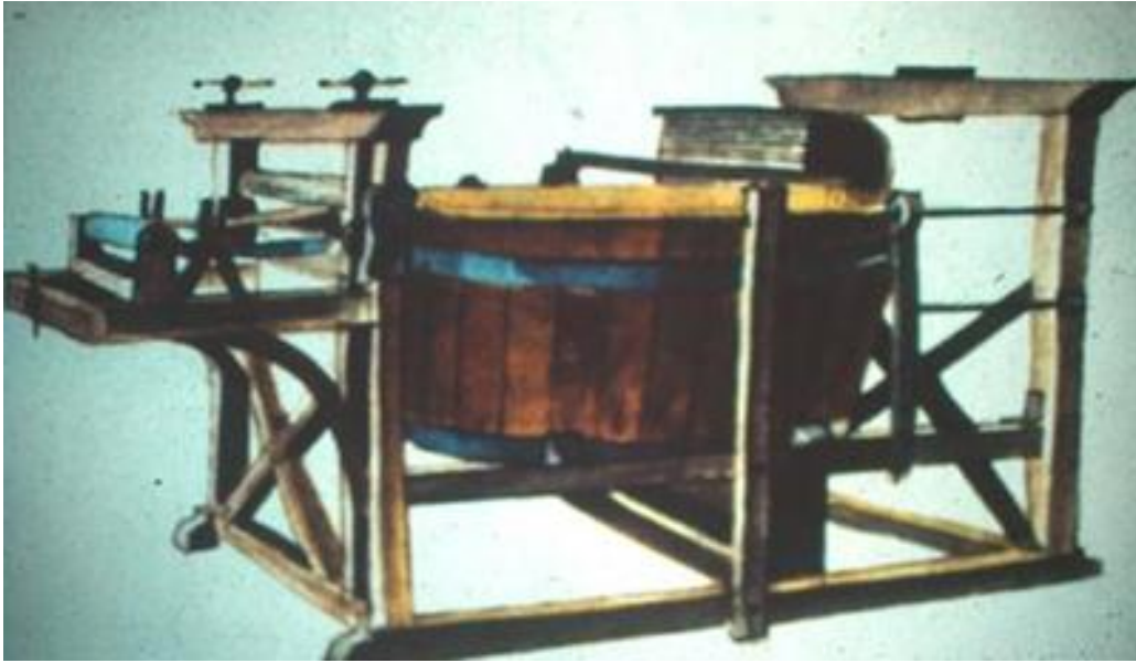
Imagen 17: Modelo de la primera máquina de papel continuo construida en 1798 (Disponible en: http://www.interempresas.net/Graficas/Articulos/37870-El-papel-2000-anos-de-historia.html )
