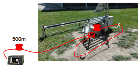
Figura 5.2: Montaje experimental del sistema soterrado en el Campus Rio Ebro. Las cruces blancas indica las posiciones concretas que se van a estudiar.
