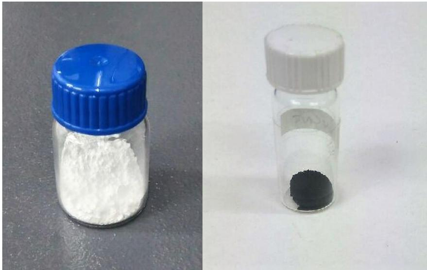
**Figura 23:** Polvo de formiato de gadolinio  $Gd(HCOO)_3$  con el que se llevó a cabo tanto la síntesis del compuesto de  $MWCNT+[Gd(HCOO)_3]$  como la pastilla prensada para la medida de la conductividad térmica (izquierda). Nanotubos de carbono empleados para la síntesis del compuesto de  $MWCNT+[Gd(HCOO)_3]$  (derecha).
