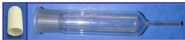
Figura 3.7. Filtro y portafiltros utilizados para la recogida de hollín.
