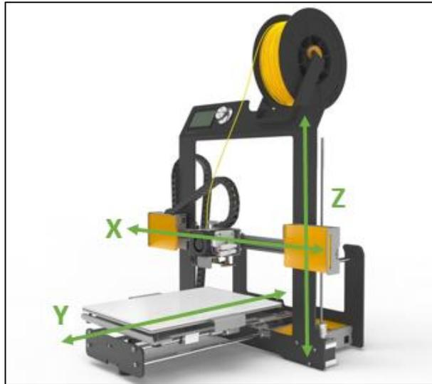
**Figura 2.9** Esquema ejes Hephestos 2
